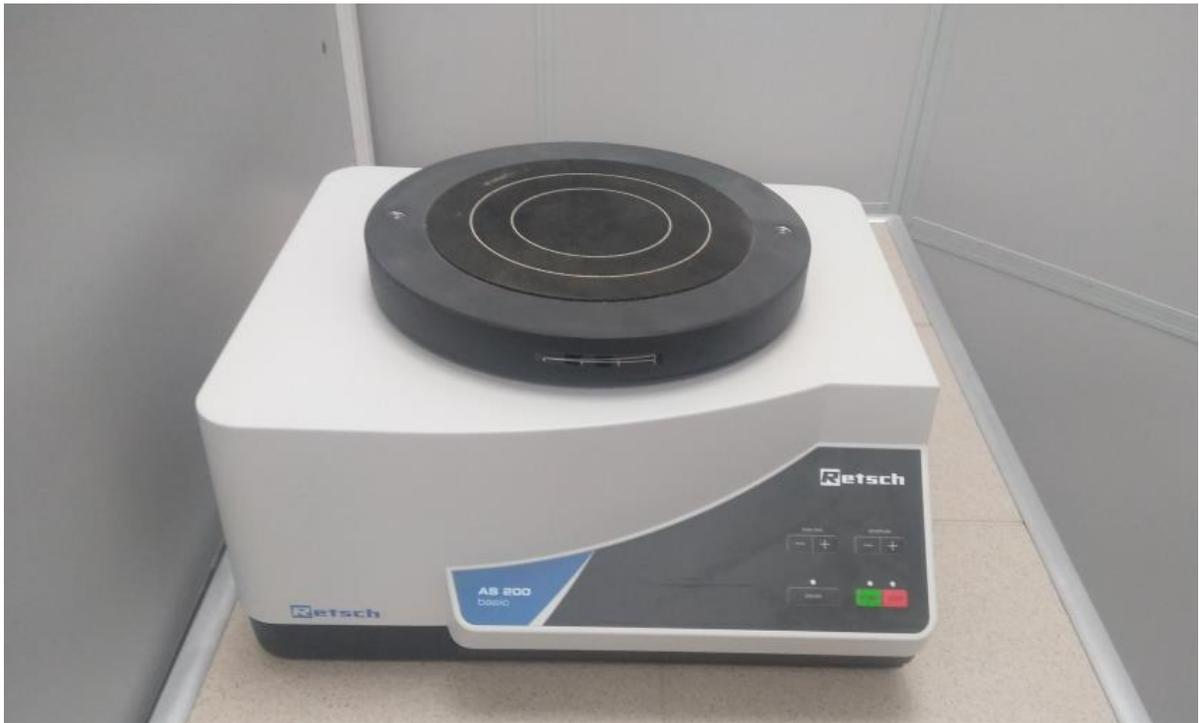
*Рис. 8. Просеивающая машина Retsch AS200*
