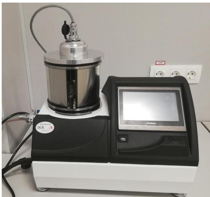
*Рис. 22. Вакуумная система для напыления тонких углеродных плёнок*
