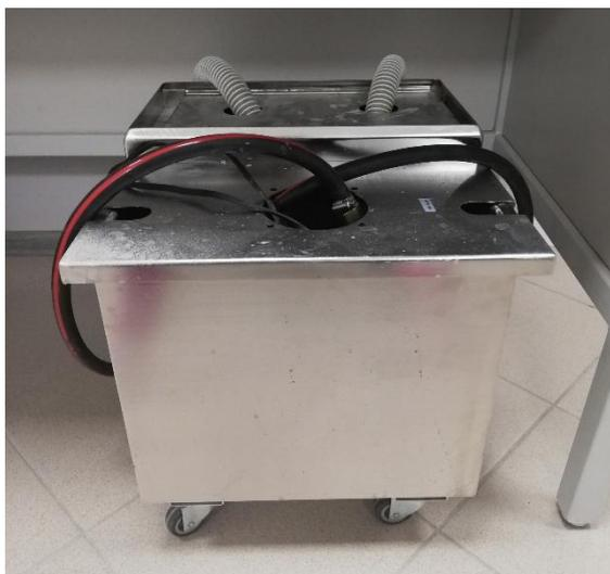
*Рис. 3. Система охлаждения отрезного станка*
