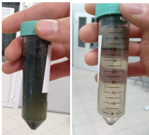
*Рис. 12. Минералы в тяжелой жидкости до (слева) и после (справа) центрифугирования*
