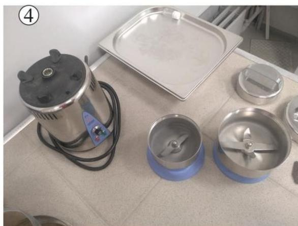
*Рис. 6. Работа с планетарной шаровой мельницей: 1 – размольные стаканы для PM400; 2 – размольные шары и крупное сито для их сбора и промывки; 3 – панель управления PM400 с выставленной программой; 4 – мельница SM-3 и два размольных стакана*
