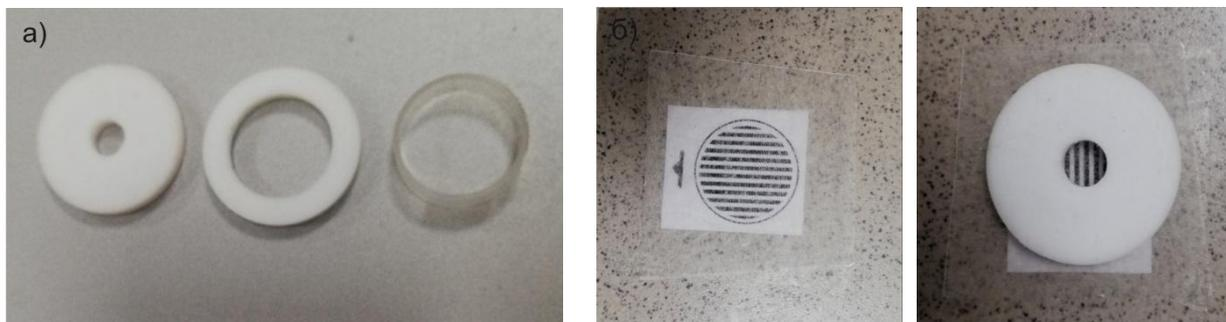
Рис. 18. Формы для заливки шашек (а), этапы подготовки к выкладке цирконов на оргстекле (б)
