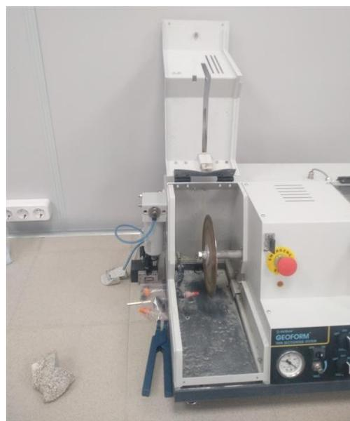
Рис. 2. Положение образца при распиливании на отрезном станке (слева); открытая крышка левого отсека станка для прочистки (справа)
