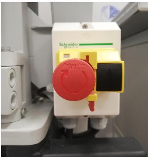
*Рис. 4. Красная кнопка экстренной остановки и чёрная кнопка запуска дробилки*
